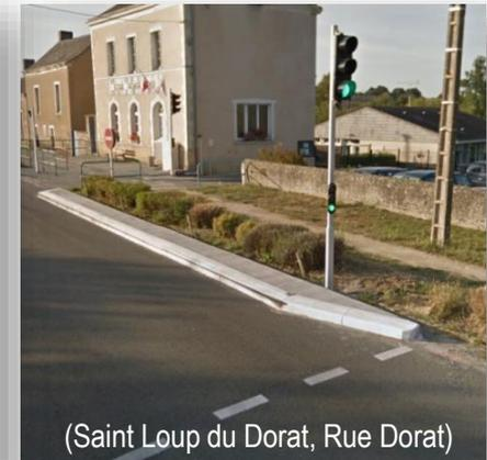
*Une bordure a été implantée pour faire ralentir les véhicules. Les traces noires attestent des frottements de pneumatiques de certains véhicules (PL et tracteurs)*
